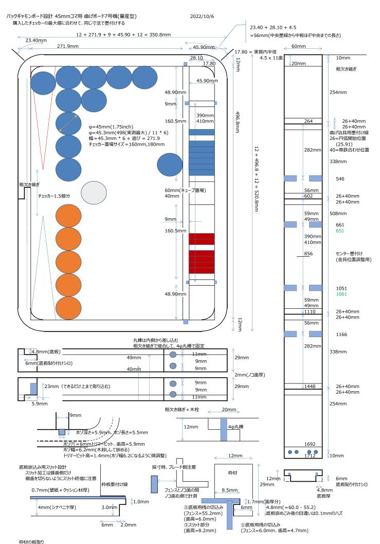
509 x 2 + 57 x 4 + 切代 = 1246 + a → 1820mm x 30mm x 9mm (1本) 中板とチェッカーストッパーの板取り(幅=23mm) 中板(幅=23mm) (購入材を23mmに引き割り) 端材があればそちらを使うこと 498mm + 5.5mm x 2 = 509mm(2本) ダイス置場 チェッカーストッパー(幅=22mm) 60mm x 46mm x (12+9)mm(2個) レストスペース 46mm + 5.5mm x 2 = 57mm(4本) チェッカー置き場を8角形のレストスペースにする 14mm(実寸)の三角柱 (160.5mm x 8本) 900mm (2本) 長さはチェッカーレスト組上げ後、実寸する トラベル=18mm 23mm 24mm 5.5mm 16mm 14mm 14mm ↑20mm 23mm トラベル=23mm **∮**5mm 5.9mm 9mm 46.39mm 12mm 14mmの三角材なら彫り込む必要なし
